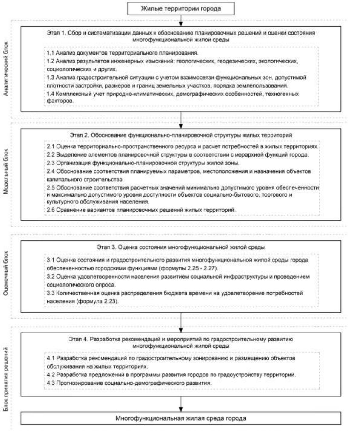
Рисунок 2.3 – Блок-схема реализации методики обоснования функционально-планировочной организации жилых территорий
