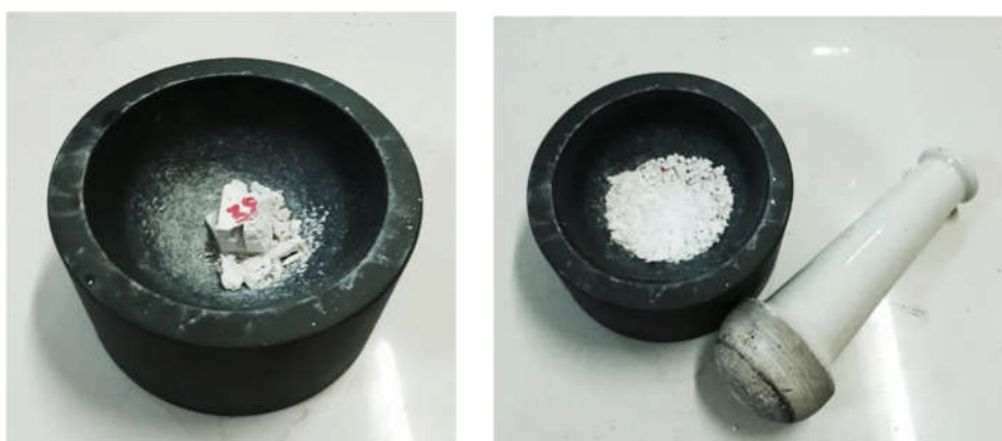
Рисунок 3.2 – Измельчение гипсового образца
