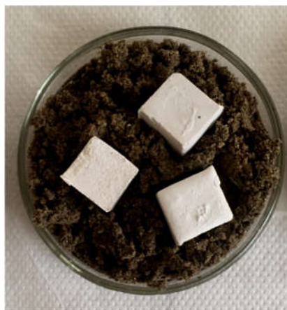
Рисунок 3.3 – Искусственный магниальный камень в техногенном дисперсном грунте
