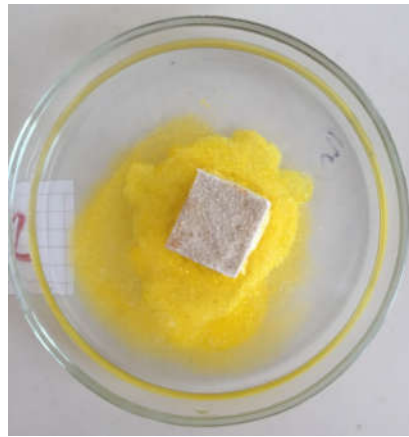
Рисунок 3.9 – Геоиндикация свинца с использованием модифицированного искусственного гипсового камня
