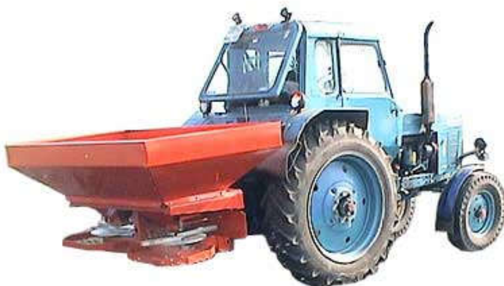
Рисунок В.1 – Машина для разбрасывания твердых минеральных удобрений (МВУ-1200)
