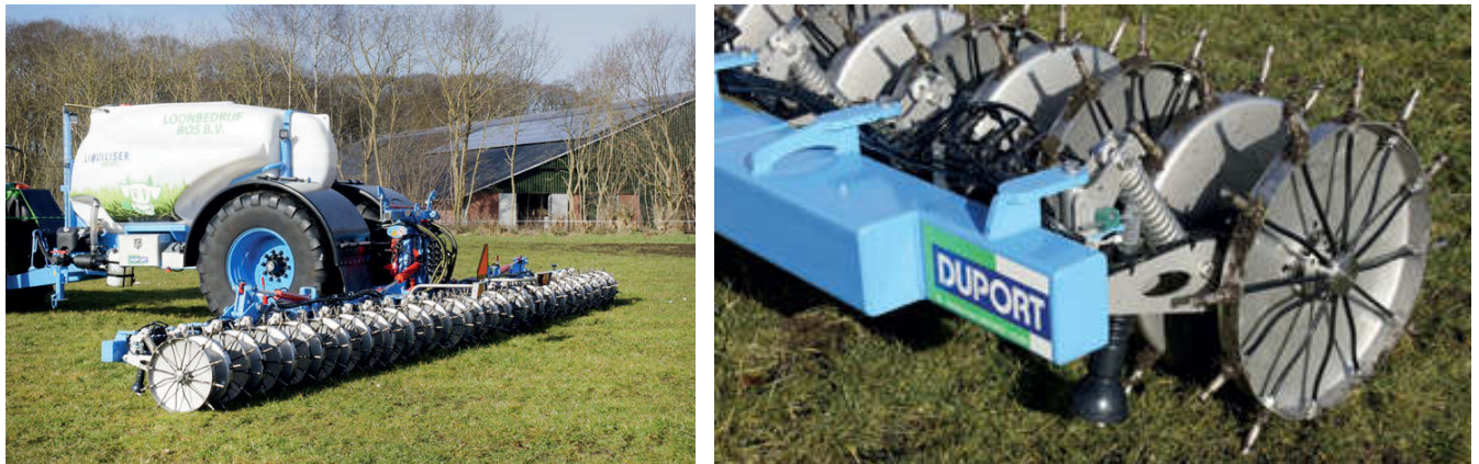
Рисунок В.3 – Ликвилайзер Duport (для способа инъектирования)
