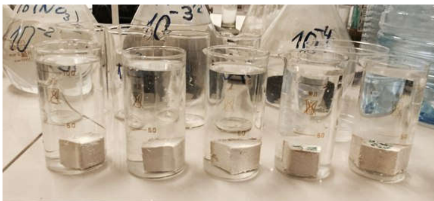
Рисунок 3.1 – Образцы искусственного гипсового камня при контакте с раствором нитрата свинца
