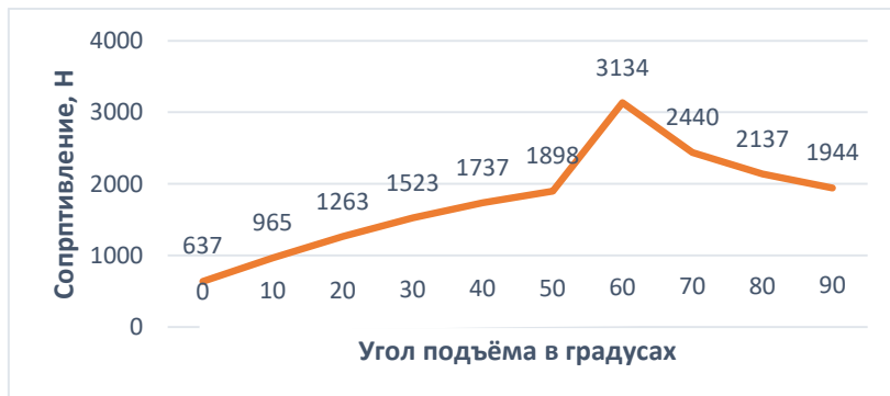
Рис. 5. Скачок сопротивления при переходе на крутонаклонный подъем
