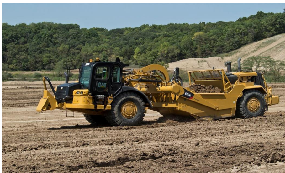
Рис.3. Скрепер срезает грунт, погружая его в кузов и транспортируя по объекту
