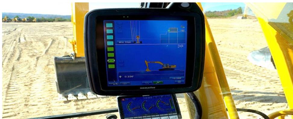
Рис. 1. Одноковшовый экскаватор с обратной лопатой и системой интеллектуального управления за работой
