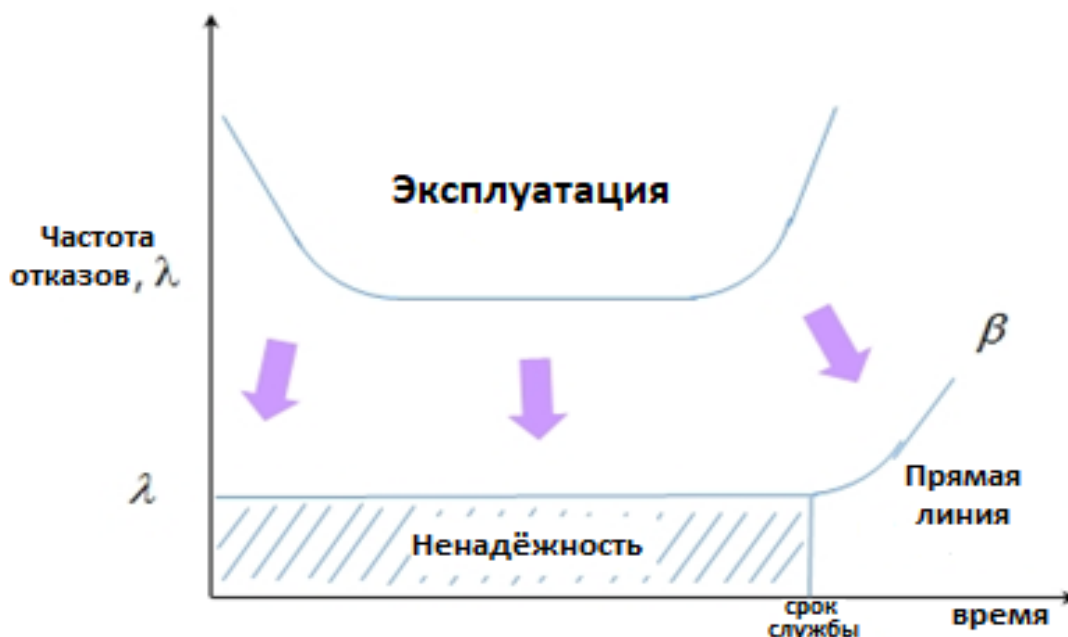
Рис. 1. Кривая надёжности и прямая линия с наклоном \beta к концу срока службы изделия
