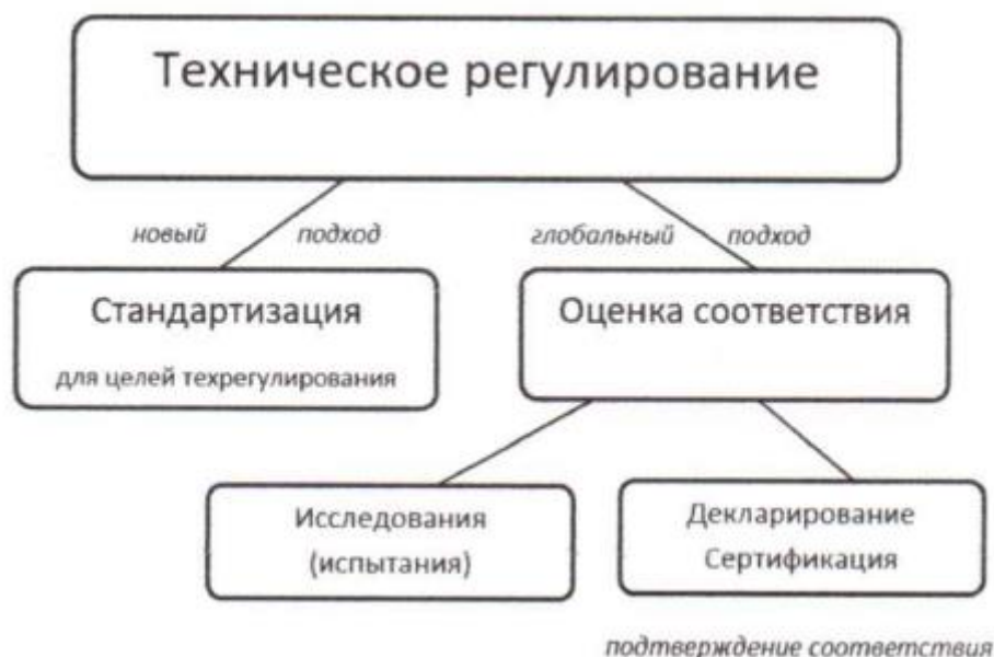
Рис. 1. Структурная схема системы технического регулирования продукции машиностроения
