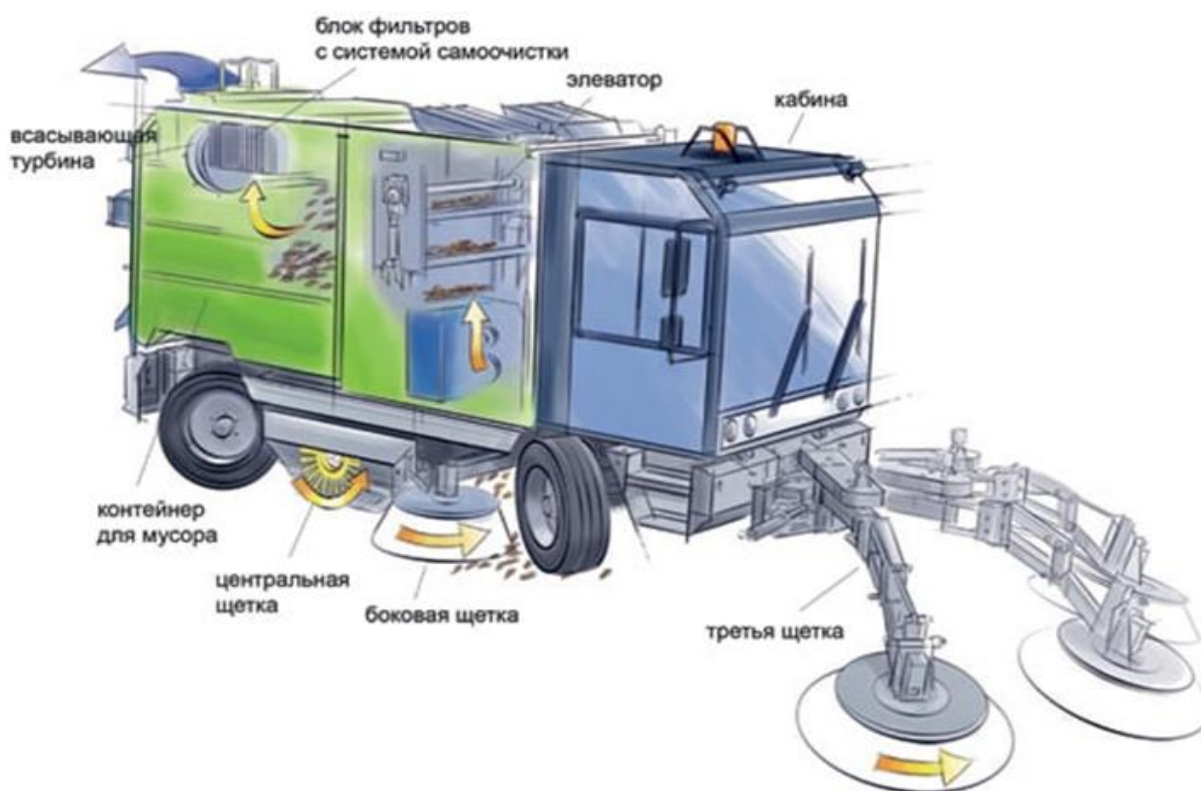
Рис. 1. Принципиальная схема работы ВПУМ
