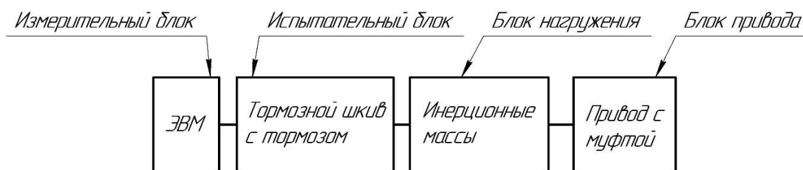
Рис. 1 Блок-схема инерционного стенда
