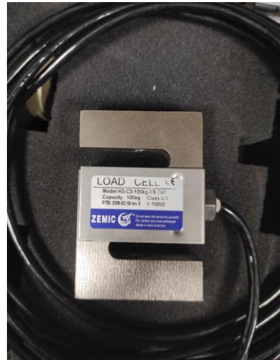
Рис. 4. S-образный тензодатчик ZEMIC H3-100kg-3B-D41
