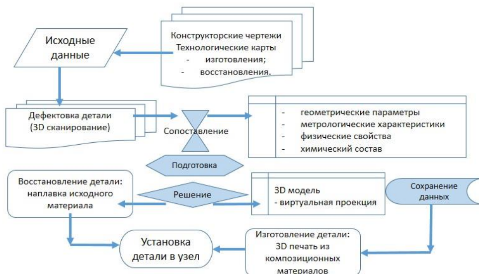
Рис. 3 Алгоритм выбора технологического процесса при ремонтных работах в условиях сервисного предприятия
