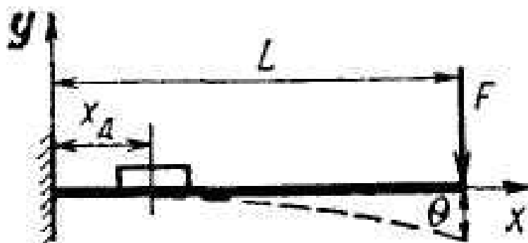
Рис. 3. Крепление тензодатчика на консольной балке
