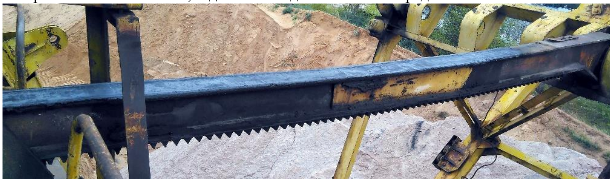
Рис. 1. Рейка механизма изменения портального крана “Albrecht”
