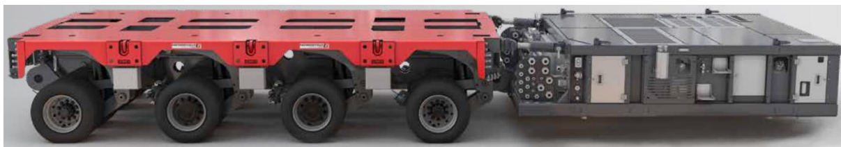
Рис. 4. Силовой блок, закрепленный на самоходной тележке (Источник: faymonville.com )
