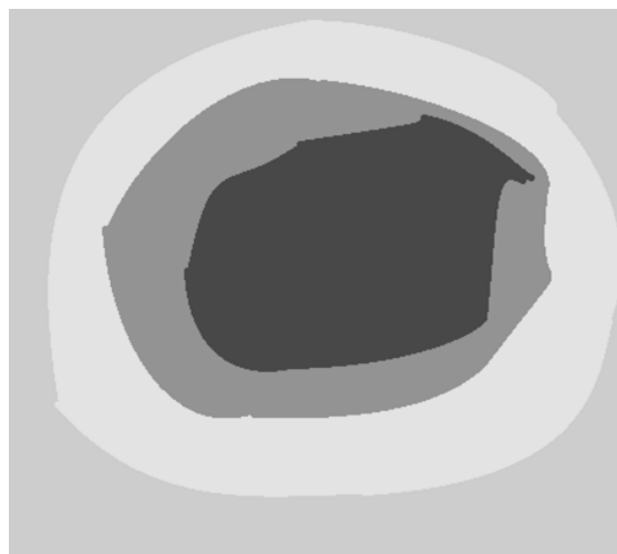
Рис. 3. Температурная карта нагрева плиты газовым способом до модернизации
