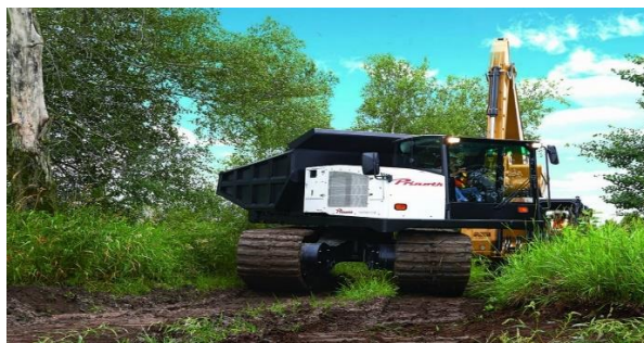
Рис.2. Думпер truplants prinoth разворачивается вокруг своей оси, для погрузки
