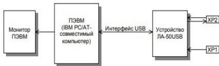
Рис. 1. Структурная схема взаимодействия АЦП ЛА-50USB.
