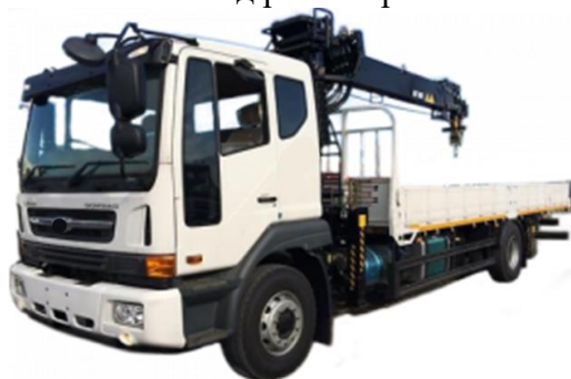
Рис. 2. Пример КМУ, установленного на автомобильное шасси
