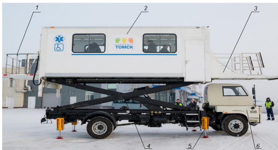
Рис. 1. Амбулифт ножничного типа: 1 – задняя подъемная платформа; 2 – кузов; 3 – передняя платформа; 4 – ножничный механизм; 5 – выносные опоры; 6 – кабина
