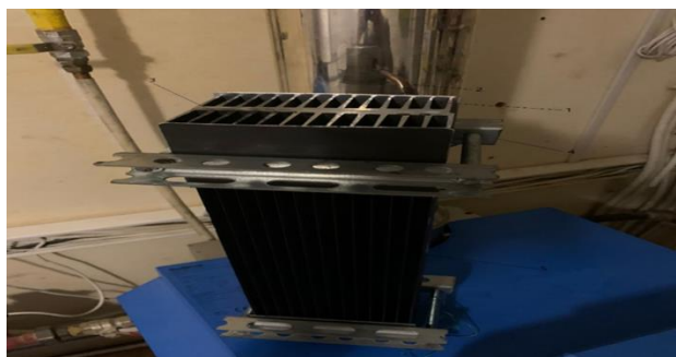
Рисунок 1. Экспериментальная установка конденсационного экономайзера
