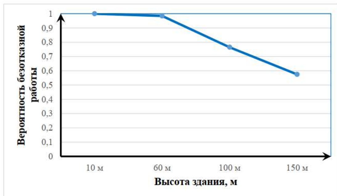
Рис.3. График зависимости «высота здания - вероятность безотказной работы»
