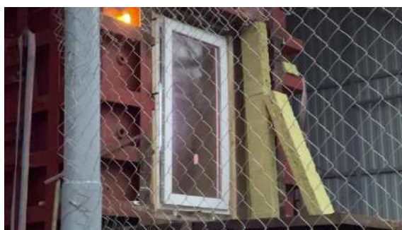
Рис. 5. Начало вскрытия образца ЛСК №1 в момент времени 144 мс.
