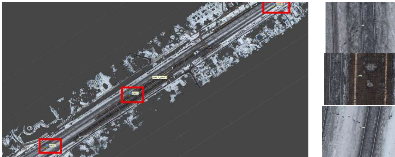
Рис. 4. Схема выбора характерных точек и их графическое отображение на снимках
