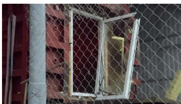
Рис. 7. Образец ЛСК №1 после испытания.
