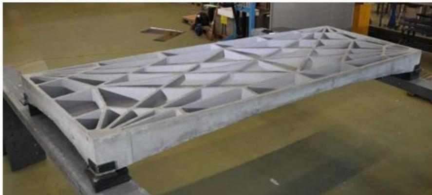
Рис.2 Макет ультра-тонкой арочной плиты перекрытия
