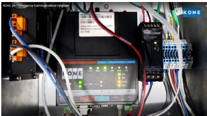
Рис. 2. Сетевой шлюз KONE Connection 210
