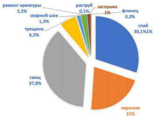
Рис. 5. Дефекты водопроводных труб
