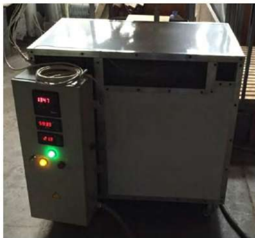
Рис. 1. Теплоаккумуляционный электроотопительный прибор для животноводческих помещений [17]
