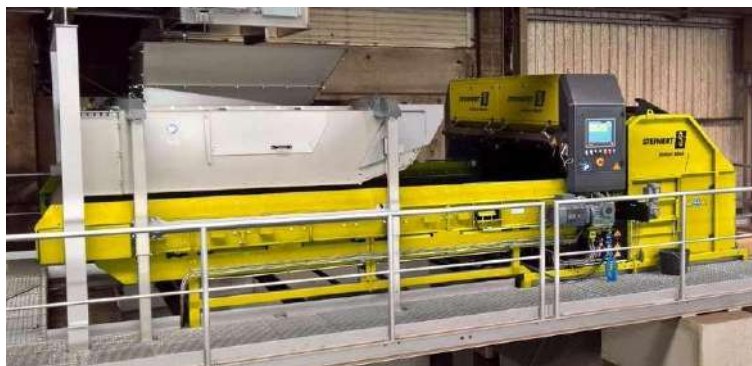
Рис. 3. «Лазерно-индуцированная пробойная спектроскопия (LIBS)»
