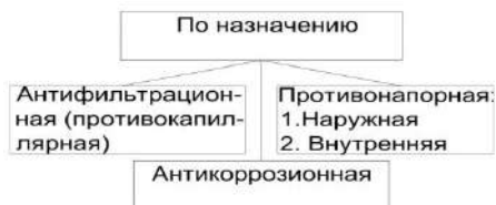
Рис. 1. Схема видов гидроизоляции по назначению
