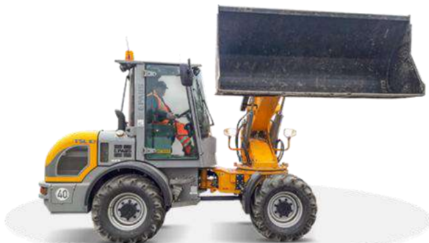
Рис. 4. Фронтальный погрузчик Paus с телескопической поворотной стрелой
