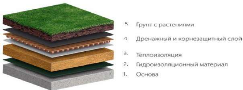
Рис. 1. Устройство инверсионной кровли:
