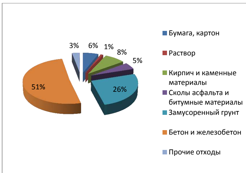
Рис. 1. Процентное соотношение отдельных элементов в общей массе строительных отходов, образующихся при сносе зданий и сооружений
