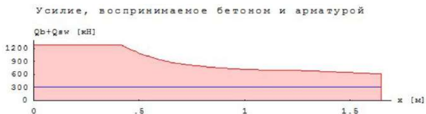
Рис. 2. Результаты расчета наклонных сечений на припорном участке колонны с учетом железобетонной обоймы усиления (синей линией показана поперечная сила в колонне)
