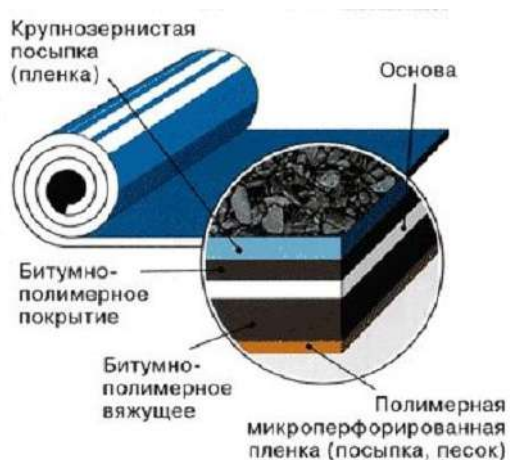
Рис. 1. Структура наплавляемой кровли
