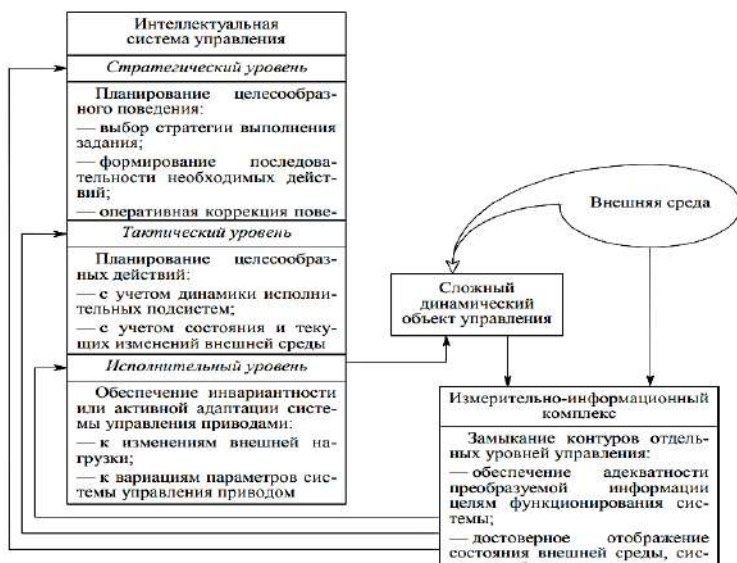
Рис. 1. Иерархическое построение интеллектуальной системы управления
