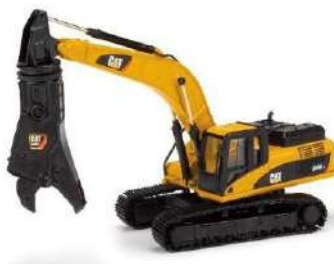
Рис. 2. Сменное рабочее оборудование гидравлические ножницы на базовой машине
