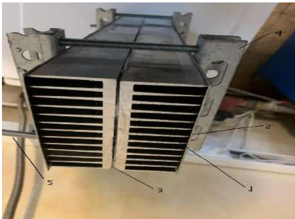
Рис. 1. Экспериментальная установка конденсационного экономайзера 1) Каналы для движения дымовых газов, 2) Штуцеры для присоединения к системам подачи воды, 3) Каналы для движения подогреваемой воды, 4) Струбцина для скрепления между собой модульных алюминиевых профилей, 5) Пластика для создания канала, по которому движутся дымовые газы
