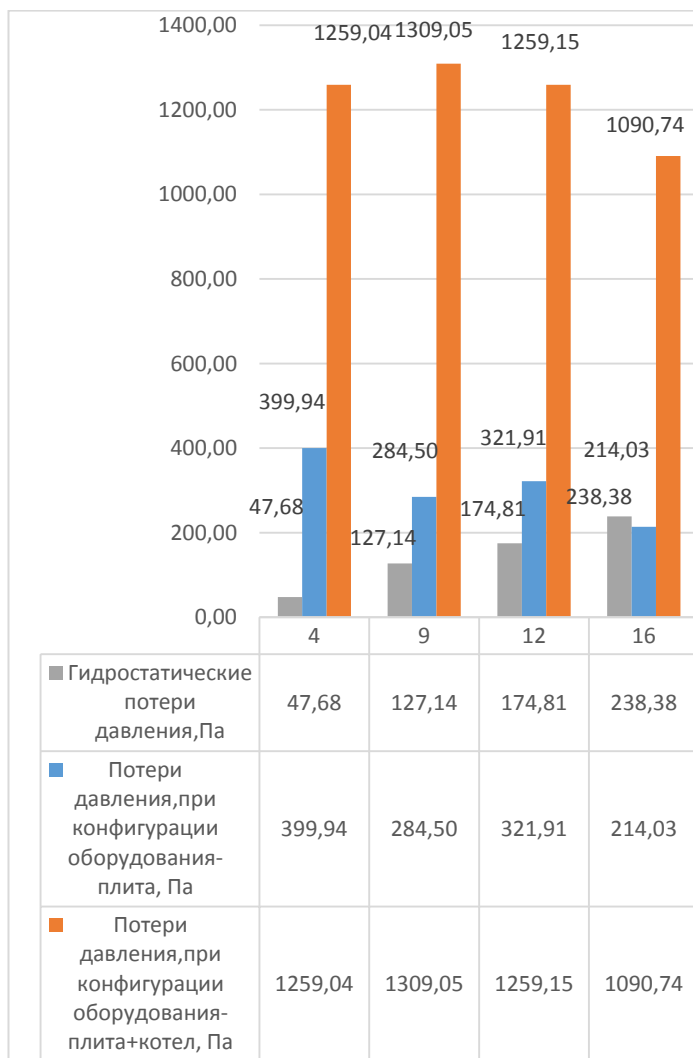
Рис. 3. График потерь давления для конфигурации плита и котел при расчете с коэффициентом неравномерности
