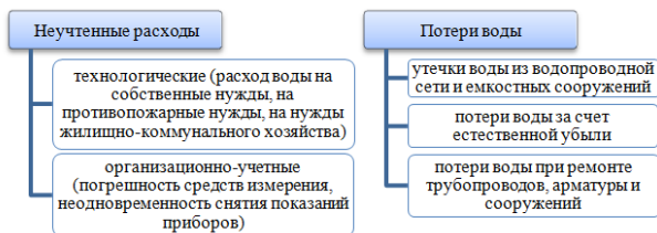
Рис. 4. Структура потерь и непроизводительных расходов в системе водоснабжения объектов ЖКХ
