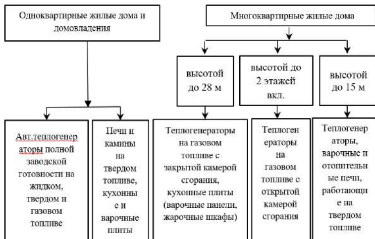
Рис. 1. Допустимость установки топливоиспользующего оборудования в жилых домах
