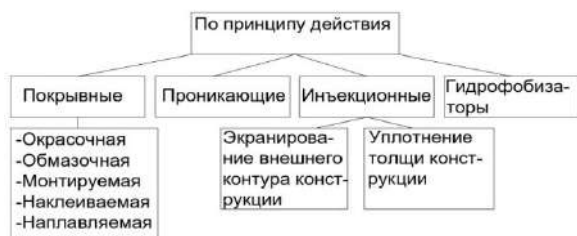
Рис. 2. Схема видов гидроизоляции по принципу действия
