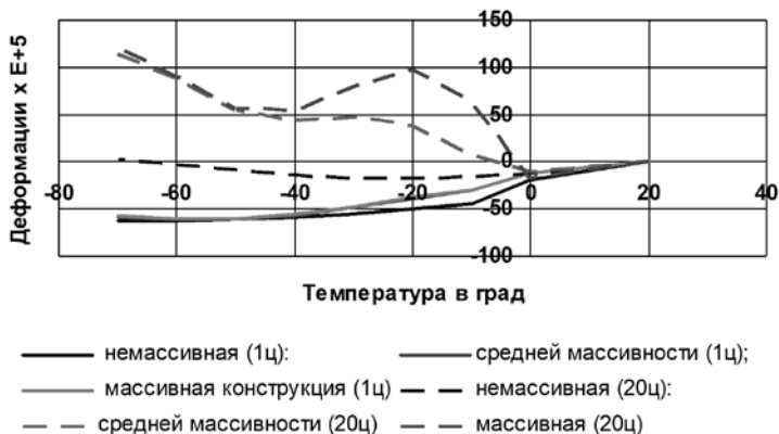
Рис.1. Температурные деформации фибробетона на первом и двадцатом циклах замораживания-оттаивания
