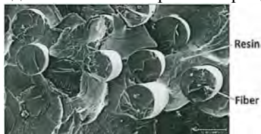
Рис. 1. Увеличенное изображение CFRP через электронный микроскоп [3]
