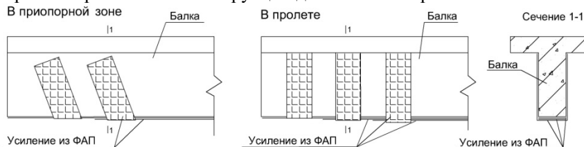
Рис. 2. Принципиальная схема усиления балки
