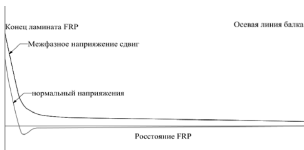
Рис. 5. Диаграмма распределения сдвиговых усилий по зоне контакта системы усиления и поверхностью бетона
