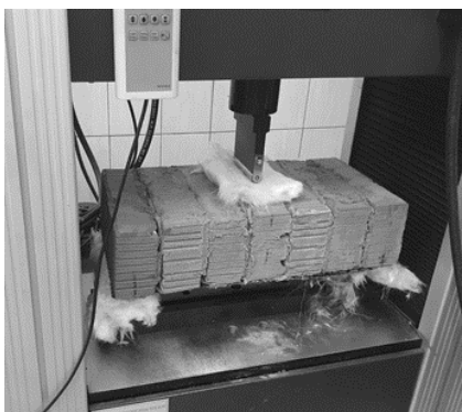
Рис. 2. Схема испытаний образцов кладки
