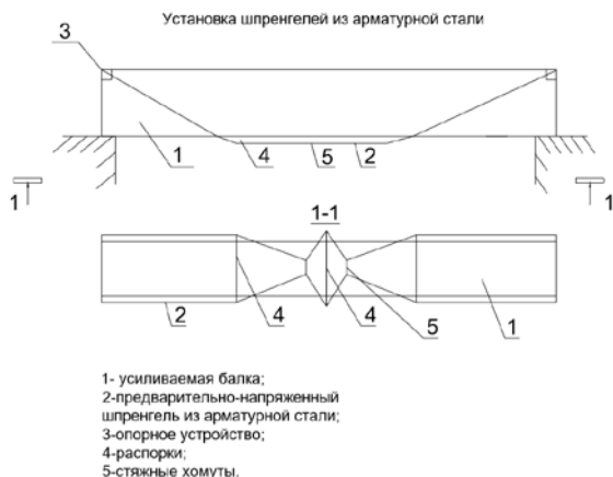
Рис.1. Установка шпренгелей из арматурной стали
