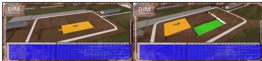
Рис.3. Зонирование строительной площадки в BIM-модели
