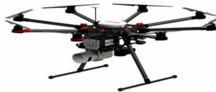
Рис.3. Мультикоптер с лидаром
