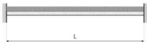
Рис. 1. Исследуема балка, защемлённая с двух концов с равномерно распределённой нагрузкой
