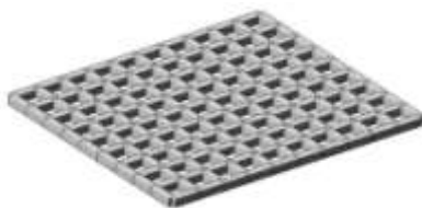
Рис. 1. Моделирование сетки ребер стержневыми элементами (пространственная модель)
