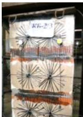
Рис. 2. Схема усиления фрагмента каменной кладки
