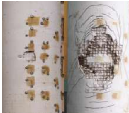
Рис.2. Разрушение при локальном нагружении от продавливания и местного изгиба с продавливанием
