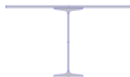
Рис. 2. Схема поперечного сечения второстепенной балки с учетом включения в работу настила
