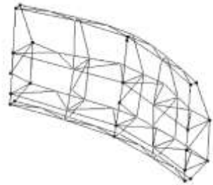
Рис. 5. Деформированная расчетная схема затвора
