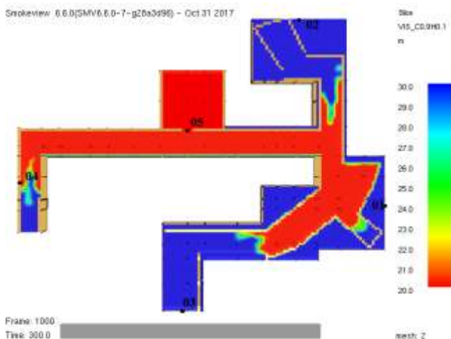
Рис. 1 Динамика распространения дыма в течении 300 секунд
