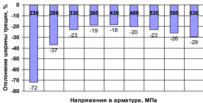
Рис.2. Отклонения ширины раскрытие трещин в балках ( \Delta_a )
