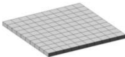
Рис. 3. Моделирование перекрытия условной изотропной плитой постоянной толщины (пространственная модель)
