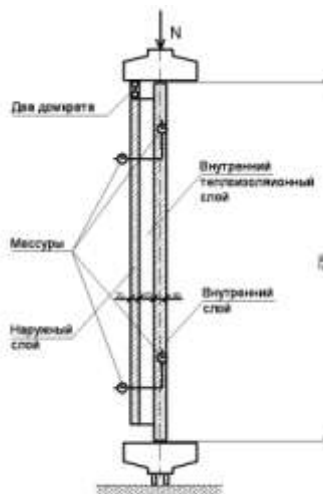
Рис. 1.Схема испытаний по методике ЦНИИЭП Жилища
