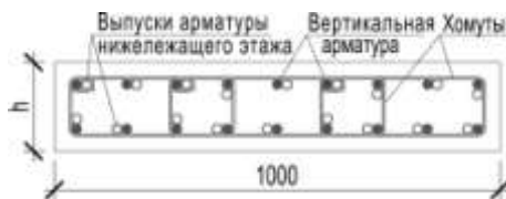
Рис. 1. Схема размещения арматуры в зоне стыковки внахлестку
