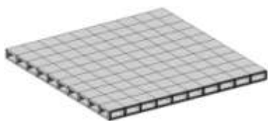
Рис. 2. Моделирование плиты и ребер оболочечными элементами (пространственная модель)
