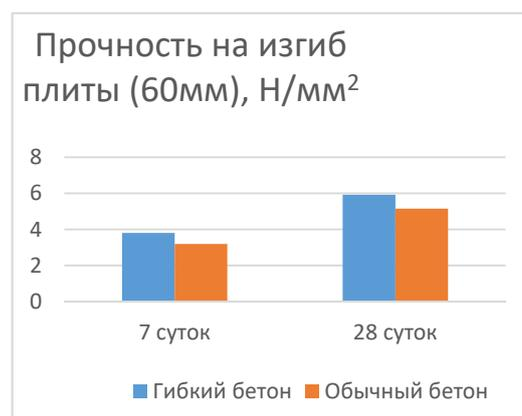
**Рис.9.** Сравнительные диаграммы прогиба бетона при изгибе
