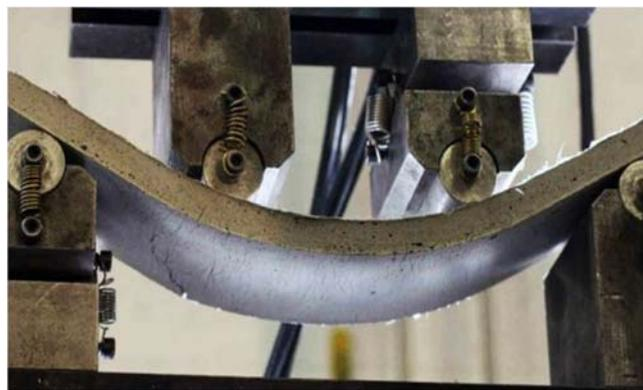
Рис.4. Прогиб плиты из гибкого бетона
