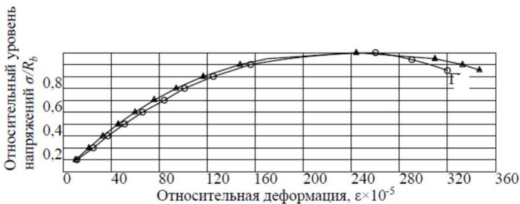
**Рис. 2.** Полная диаграмма деформирования бетона  $\sigma/R_b - \varepsilon$  (1 серия): о-эксперимент; Δ-по формуле (1)
