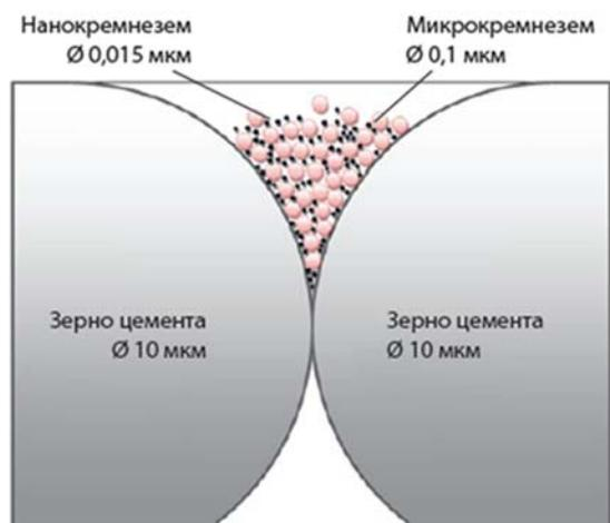
**Рис. 2.** Заполнение межцементного пространства частицами нано- и микрокремнезема.
