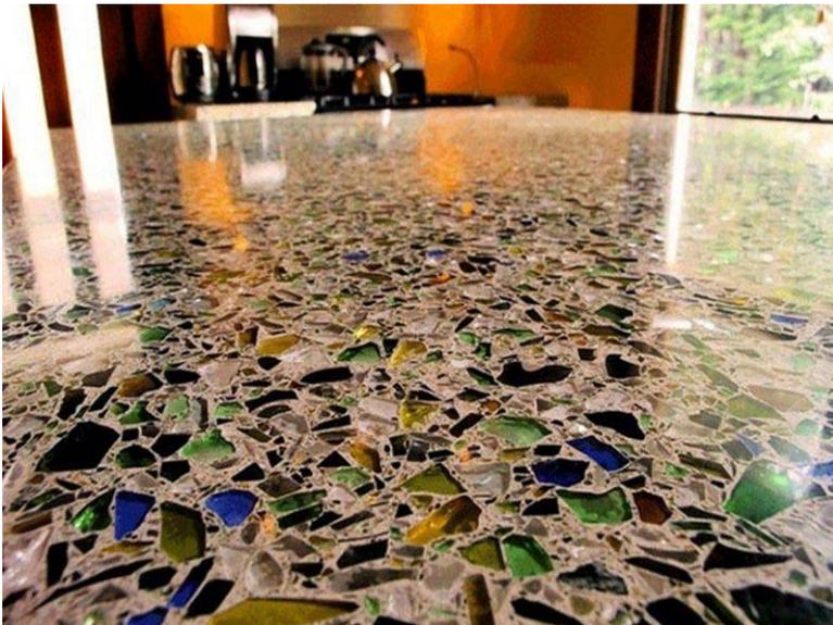
**Рис. 3.** Панель из шлифованного стеклонаполненного бетона.
