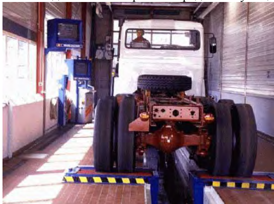
Рис. 1. Роликовый тормозной стенд для грузовых автомобилей с максимальной нагрузкой на ось до 18 т IW 7/E немецкой фирмы «МАНА»
