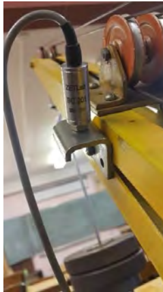
Рис. 2. Установка акселерометра на стрелу
