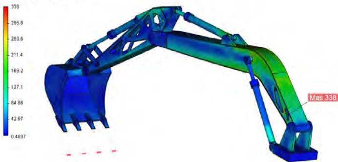
Рис. 2. Напряжения в стреле при копании всей шириной ковша
