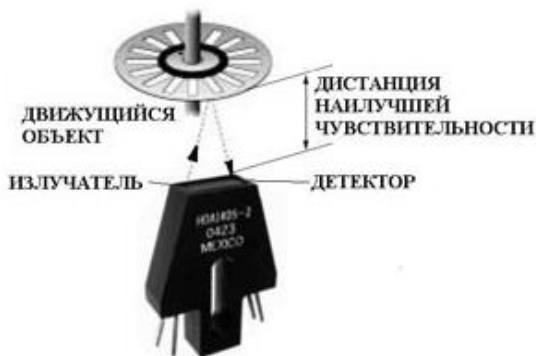
Рис. 2. Принцип работы оптического датчика скорости, работающего по методу отражения
