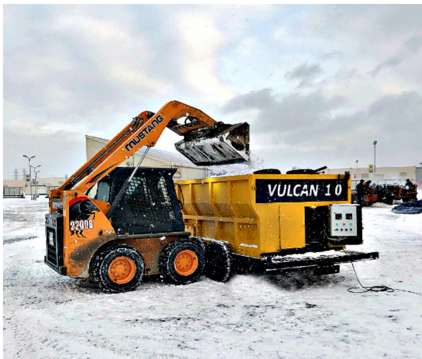
Рис. 3. Мобильная снеготаялка VULCAN
