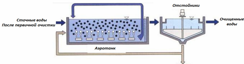
Рис. 1. Схема биологической очистки с комбинированием применения биопленки и активного ила
