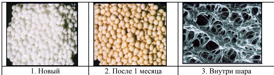
Рис. 2. Материал PVA Gel – новый, после 1 месяца эксплуатации и внутренняя структура
