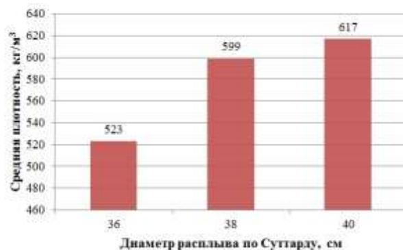
Рис. 7. График зависимости средней плотности образцов газобетона от диаметра расплыва по Суттарду
