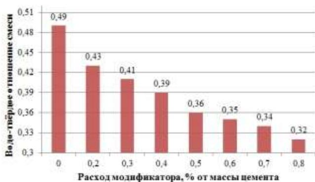
Рис. 1. График зависимости водо-твёрдого отношения газобетонной смеси от расхода модификатора
