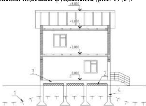
Рис. 1. Теоретическая кривая нулевой изотермы в период максимального оттаивания мерзлого грунта: 1 – граница сезонного оттаивания; 2 – теплоизоляционный экран; 3 - фундаментная балка; 4 – буронабивной малозаглубленный свайный фундамент с уширенной опорой
