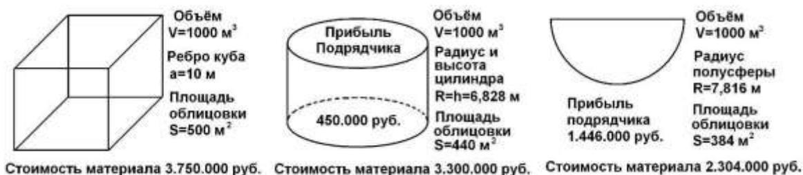
Рис. 1. Изменение формы конструкции по Дополнительному соглашению
