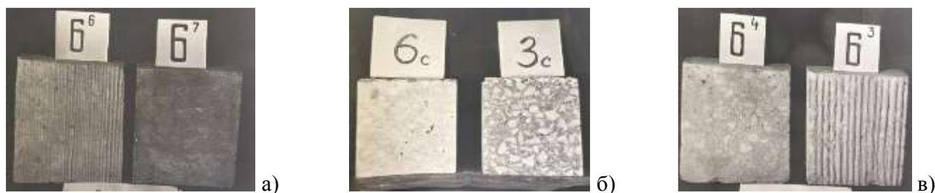
Рис. 2. Кубики декоративного бетона до шлифовки и после для проведения лабораторных испытаний с различными типами заполнителя
