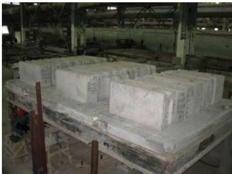
Рис. 3. Приложение нагрузки на 4 ступени.
