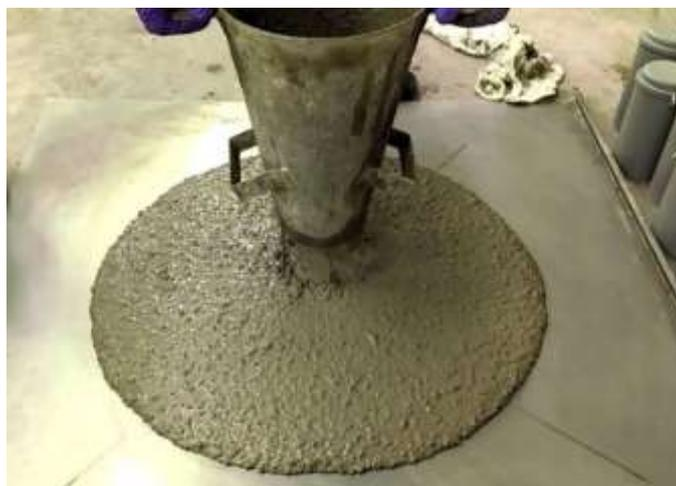
Рис. 1. Определение удобоукладываемости самоуплотняющейся бетонной смеси.
