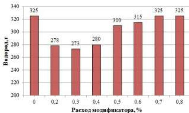
Рис. 3. График зависимости количество выделившегося водорода в газобетонной смеси от расхода модификатора
