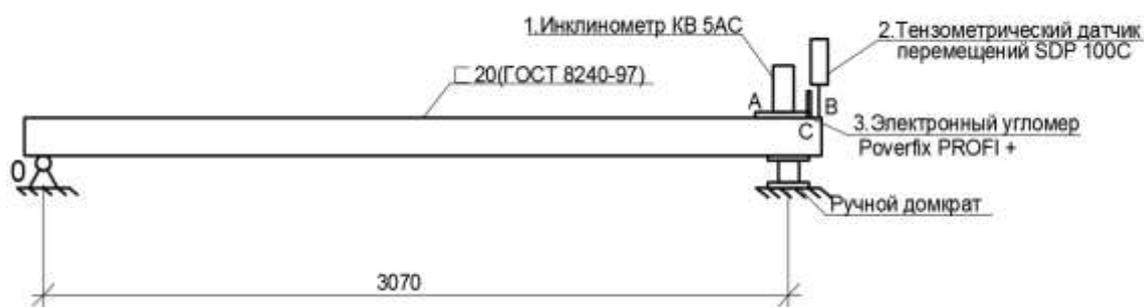
Рис.1. Измерение угла поворота балки из швеллера
