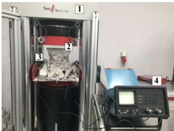
Рис. 1. Общий вид испытаний образцов-кубов:
