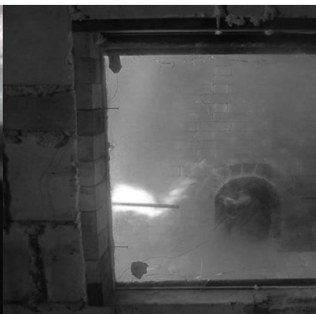
Рис. 2. «Состояние стекла при температуре 600 градусов Цельсия»
