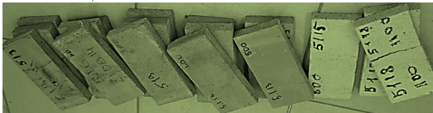
Рис. 7. Изменение цвета образцов после температурного воздействия
