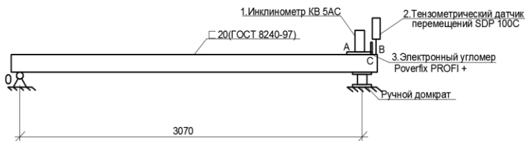
Рис.1 Измерение угла поворота балки из швеллера
