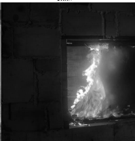
Рис. 4. «Выпадение стекла из стандартной рамки. Конец испытания»
