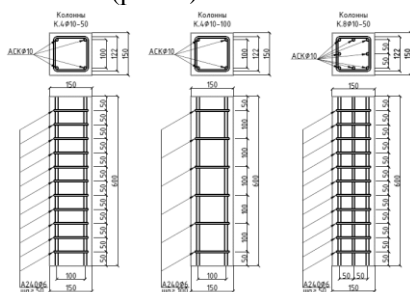
Рис. 1. Чертежи каркасов колонн
