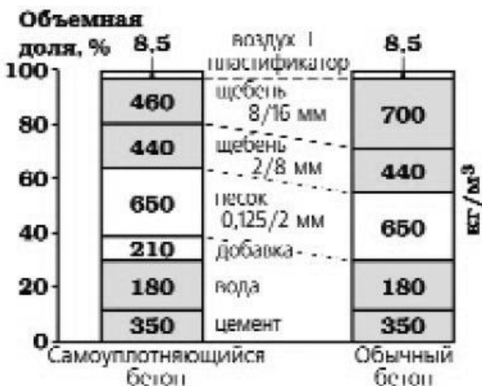
Рис.1 Сравнение бетона обычного и самоуплотняющегося.
