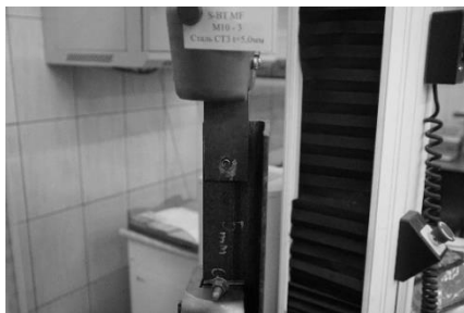
Рис. 4. Схема испытания образцов на срез
