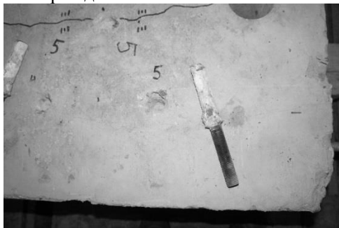
Рис. 1. Характер разрушения образцов серий 1-4
