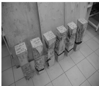
Рис. 2. Характер разрушения колонн
