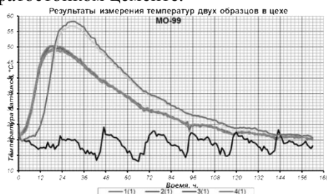
Рис. 3. Результаты замера температур твердеющего бетона
