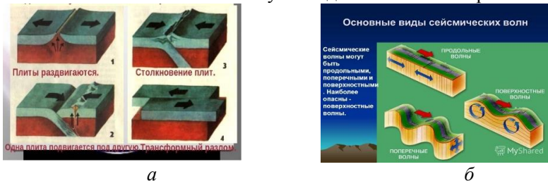
Рис. 1: а) Результат внезапного разрыва сплошного вещества Земли и смещения отдельных участков земной коры. б) Распространение сейсмические волны на поверхности земле
