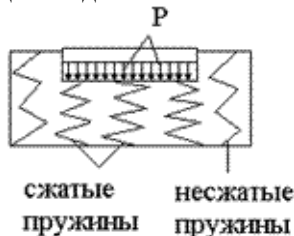
Рис. 1. Схема модели основания для расчёта гибкой конструкции на упругом основании по методу местных упругих деформаций
