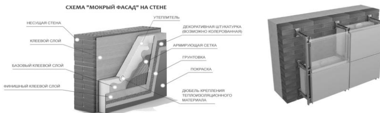
Рис.2. «Мокрый фасад» и вентилируемый фасад
