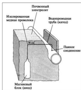
Рис. 2. Протекторная защита
