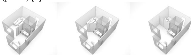
Рис. 1. Планировка квартиры с трансформируемой перегородкой
