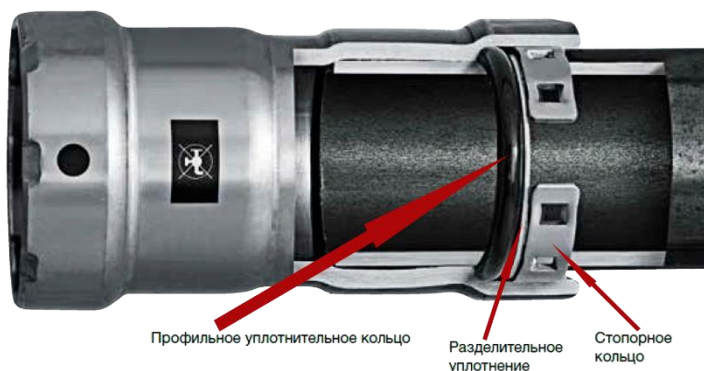
Рис. 1. Строение пресс-фитинга.
