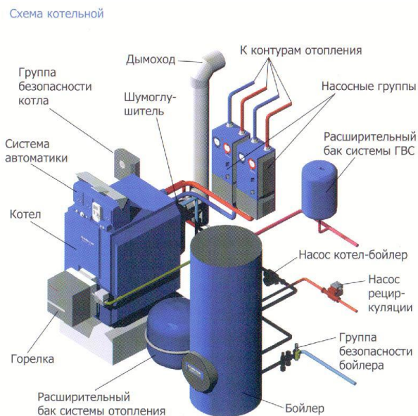
Рис. 1. Устройство котельной установки [3].
