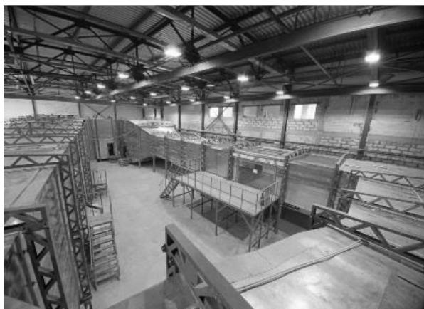
*Рисунок 2. Большая градиентная аэродинамическая труба НИУ МГСУ*
