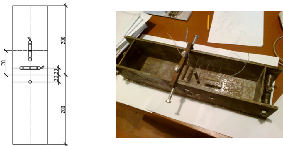
Рис. 2 – Схема расположения глубинных датчиков в опалубке
