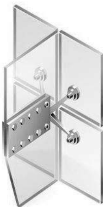
Рис.5. Крепление спайдера к стеклянному ребру.
