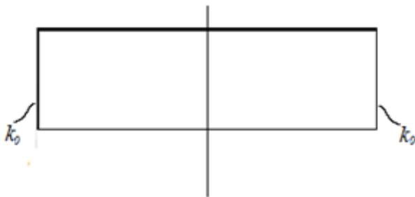
Рис.2. Характер изменения коэффициента постели при  $\alpha = 0$
