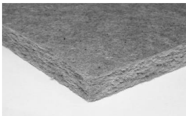
Рис. 2. Утеплитель из ДВП
