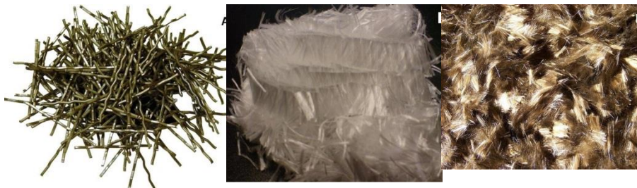
Рис. 1. Армирующее волокно: а – стальная фибра; б – полипропиленовое волокно; в – минеральное волокно
