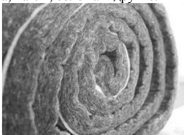
Рис. 1. Утеплитель из овечьей шерсти
