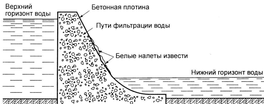
Рис. 1. Растворение и вынос гидроксида кальция из бетона плотины
