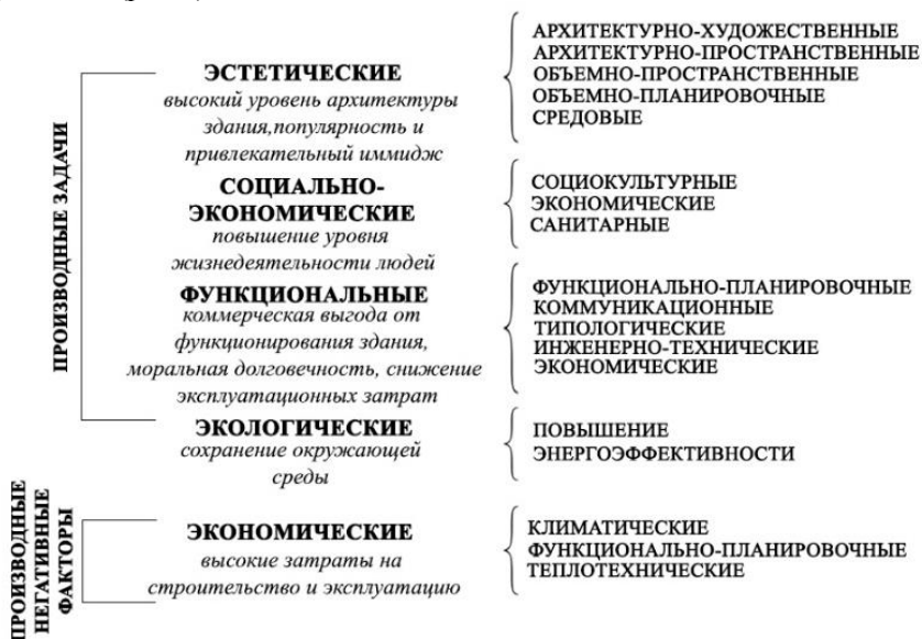
Рис. 2. Производные задачи и негативные факторы, которые следует учитывать при проектировании атриума
