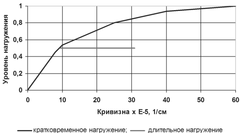
Рис.2. Зависимость кривизны от уровня нагружения
