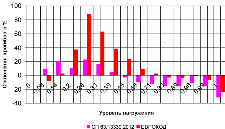
Рис.3. Отклонение расчетных прогибов от опытных данных
