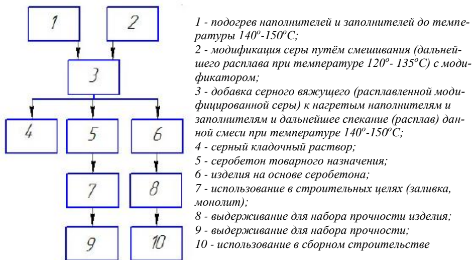
Рис. 2. Схема технологии производства серобетона
