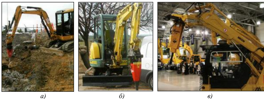
Рис. 4. Гидромолоты на базе малогабаритных экскаваторов (а, б) и мини-погрузчика с бортовым поворотом (в)
