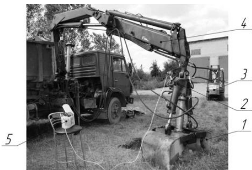
Рис. 2. Крано-манипуляторная установка с экспериментальным грейферным оборудованием: 1 – экспериментальный грейферный ковш; 2 – датчик давления ИПД-2; 3 – погрузчик с мерной бочкой; 4 – крано-манипуляторная установка НИАВ на шасси автомобиля КаМАЗ; 5 – модуль сбора данных МСД-200
