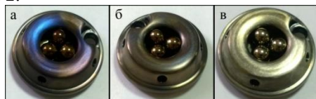
Рис. 2. Фотографии оправки после испытания масел: а – масло А; б – масло Б; в – масло В
