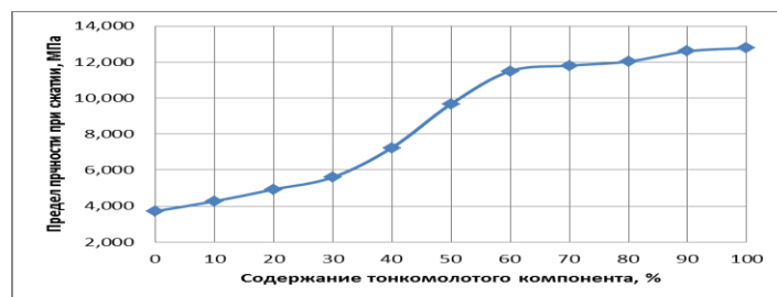
Рис.1. Зависимость прочности при сжатии гипсового камня от содержания тонкомолотого компонента в составе бинарной дисперсной системы на основе полугидрата сульфата кальция
